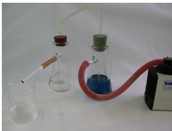
תמונה 1 : מערכת עישון לבדיקת חומציות עשן סיגריה.
