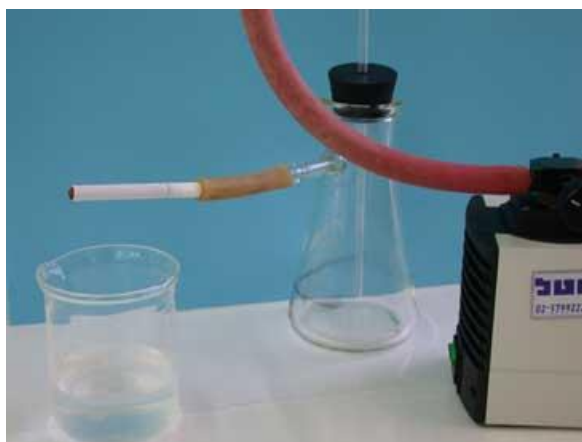
תמונה 2 : מערכת עישון לבדיקת עשן סיגריות ונרגילות
